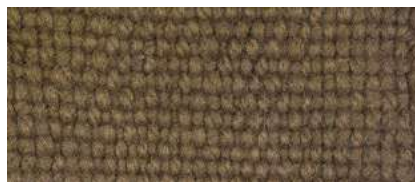
NCS S 7020-Y20R | 1114 Matico | Hoja + S. cobre | Tirúa, R. del Biobío Invierno/Primavera | Sal | Sin amoniaco
