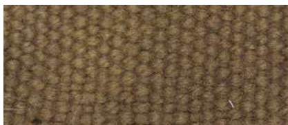
NCS S 6030-Y10R | 0347 Romaza | Hojas | Purranque, R. de los Lagos Invierno | Sal | Sin amoniaco
