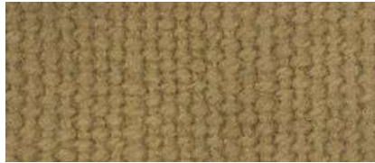
NCS S 5030-Y | 0091 Chilco | Ramas + Hojas | Carirriñe, R. de los Ríos Verano | Sin mordiente | Amoníaco
