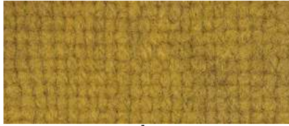
NCS S 3060-Y10R | 1927 Canelo + Avellano | Hojas | Calbuco, R. de los Lagos | Primavera/Ver. | Bicarbonato | Amoniaco
