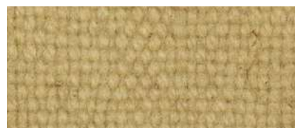
NCS S 2030-Y | 1435 Pelú | Flor | Niebla, R. de los Ríos Verano | Alumbre + Crémor | Sin amoniaco
