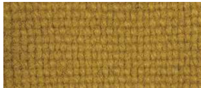
NCS S 3060-Y10R | 1443 Matico | Flor | Niebla, R. de los Ríos Verano | Sin mordiente | Sin amoniaco
