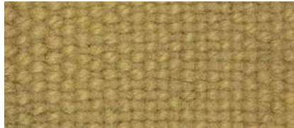
NCS S 3050-Y | 0981 Maqui | Ramas + Hojas | Teodoro Schmidt, R. de la Araucanía | Inv. | Alumbre + Crémor | Sin amoníaco
