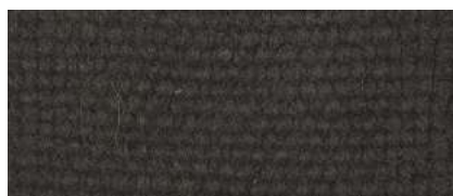
NCS S 8502-Y | 1089 Maqui | Hojas | Tirúa, R. del Biobío Invierno/Primavera | S. cobre | Amoníaco
