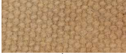
NCS S 3030-Y30R | 1563 Costilla de Vaca | Fronda | Los Pellines, R. de los Ríos Primavera | Alumbre + Crémor | Sin amoníaco
