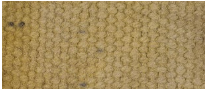
NCS S 4030-Y10R | 0041 Avellano | Hojas + Corteza | Freire, R. de la Araucanía | Invierno | S. hierro | Sin amoníaco
